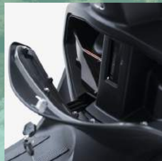
CASSETTO POSTA OGGETTI
